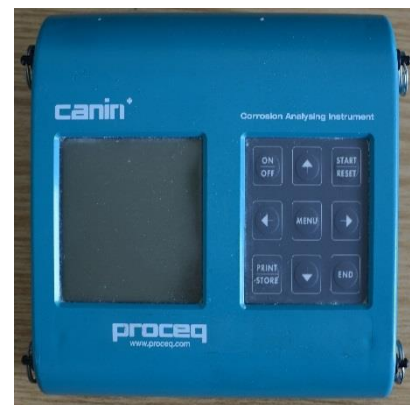
Abbildung 20: Canin+ Anzeigergerät - Front
