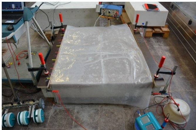
Abbildung 27: Zwecks Vorwässerung abgedeckter Probekörper
