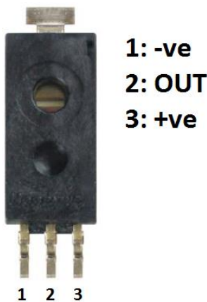
Abbildung 12: HIH- 5030 Feuchtigkeitssensor Abbildung 13: Anschlüsse für die Messung der relativen Luftfeuchte
