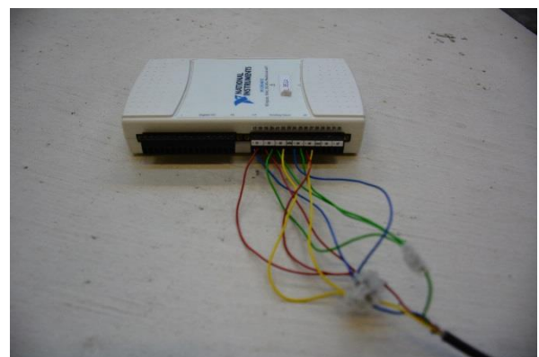
Abbildung 25: Verkabelung des DAQ im DIFF- Modus
