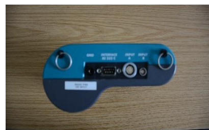
Abbildung 19: Canin+ Anzeigergerät - seitliche Anschlüsse
